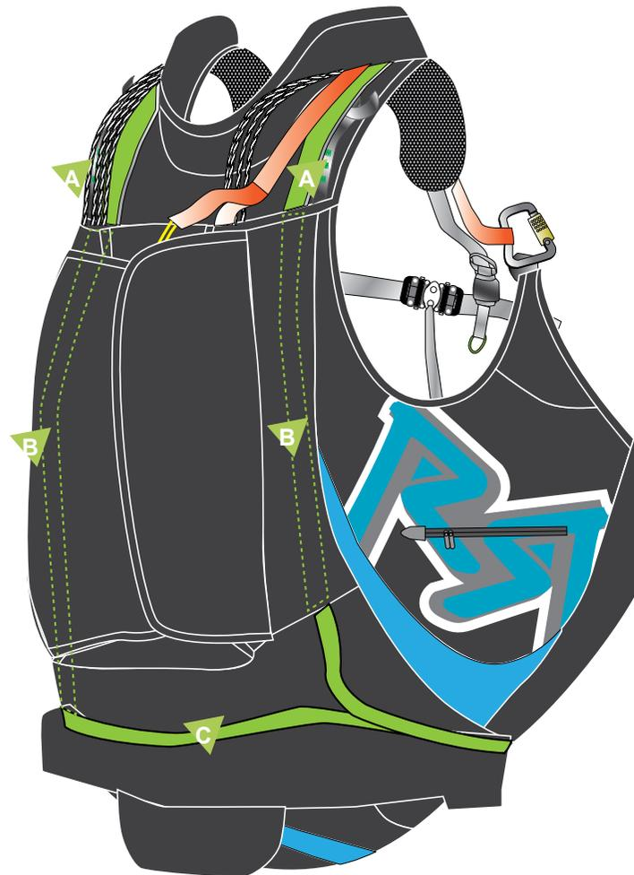
1. Colocar el Maillon Rapide® (mirando hacia arriba y hacia el exterior) en el punto de anclaje de cinta por debajo de la solapa. Colocar el anillo elástico en el maillon y enroscarlo en 8.
