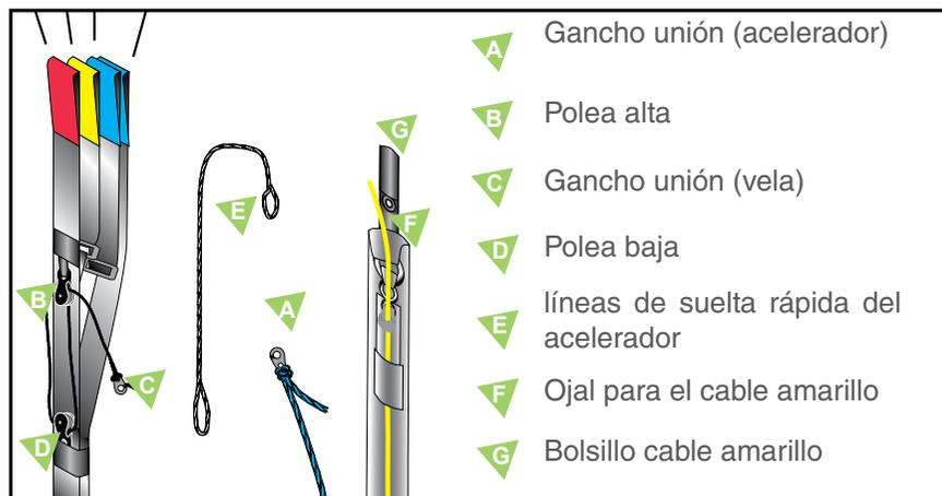
1. Quitar el gancho de unión y sacar la línea del acelerador de las poleas. Quitar esta línea completamente de la banda del parapente para que no interfiera en el funcionamiento del sistema.
