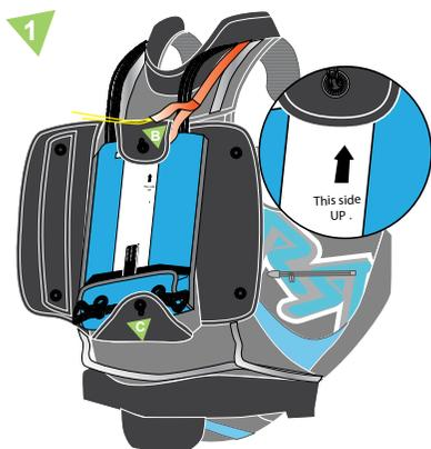
1. Colocar el contenedor respetando el sentido (ver parte «this side up») y comprobar la ausencia de twist en la cinta de conexión. Doblar las solapas superiores e inferiores.
