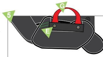
5. Con la ayuda de la cinta de plegado hacer pasar la cuerda (loop) en ojal izquierdo de la solapa inferior (E) luego en el cable del asa (G). Remover la cinta de plegado lentamente.
