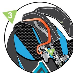
1. Colocar el contenedor de modo correcto (logo «this side up» con una flecha hacia arriba). Sacar la cinta de conexión del contenedor y colocarla por encima de la bandas derechas de la vela de BASE. Comprobar que no se haya formado ningún twist y que la cinta de conexión no gire alrededor de las bandas.
