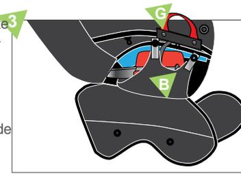
3. Volver a cerrar la solapa (A) y colocar correctamente el asa (G). Luego colocar la solapa blanda (B) cubriendo el contenedor Pod.
