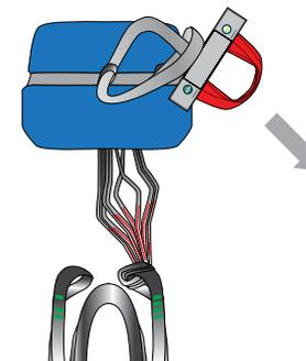
1. Pasar la cinta del asa dentro del punto de anclaje lateral y realizar un nudo de alondra con el asa.
