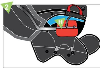
2. Colocar correctamente los elevadores del paracaídas (I) que se hayan quedado en el exterior del contenedor Pod (H) y colocarlas dentro del interior del contenedor de la silla.
