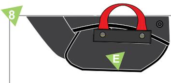
8 Guardar los toques superiores de la solapa (E) en los compartimientos previstos para tal efecto.
